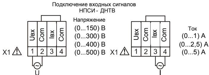
Рисунок 7а – Подключение входных сигналов к НПСИ-ДНТВ
