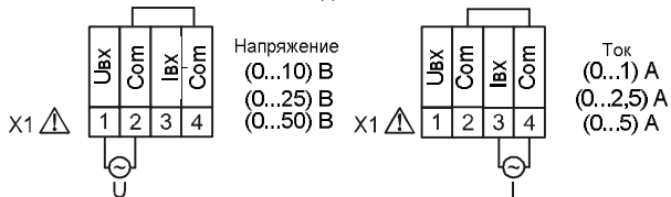
Рисунок 7б – Подключение входных сигналов к НПСИ-ДНТН
